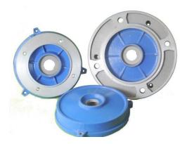
Se refiere a la tapa delantera del motor, la tradicional se llama B3, existen B14 (similar a B3 con perforaciones para acople en el interior) y B5 que corresponde a una tapa de mayor dimensión al motor y perforaciones de acoplamiento exterior. Se usan para acople directo a una máquina y para acoplar reductores de velocidad.
